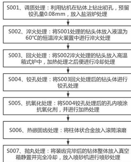
1. 一种矿山中深孔柱齿钻头热嵌固齿工艺,其特征在于,包括以下几个步骤:
